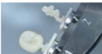
Restauraciones acabadas de tallar
