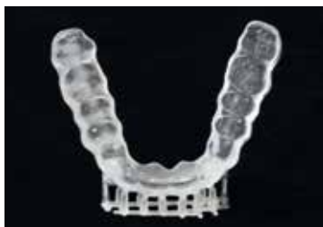
Schiene mit Supportstrukturen
