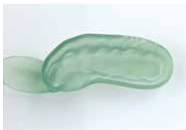
Teillöffel in hohen Schichtstärken gedruckt
