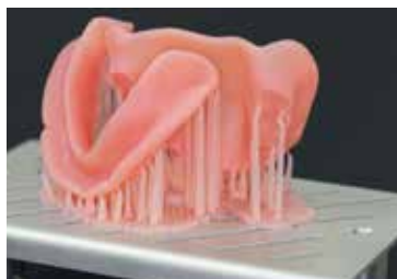
Generativ hergestellte Prothesenbasen
