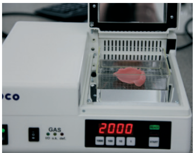
Abb. 6: Nachbelichtung der Prothesenbasis.
