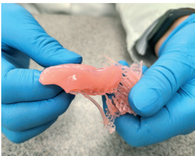
Abb. 5: Entfernung der Supports.
