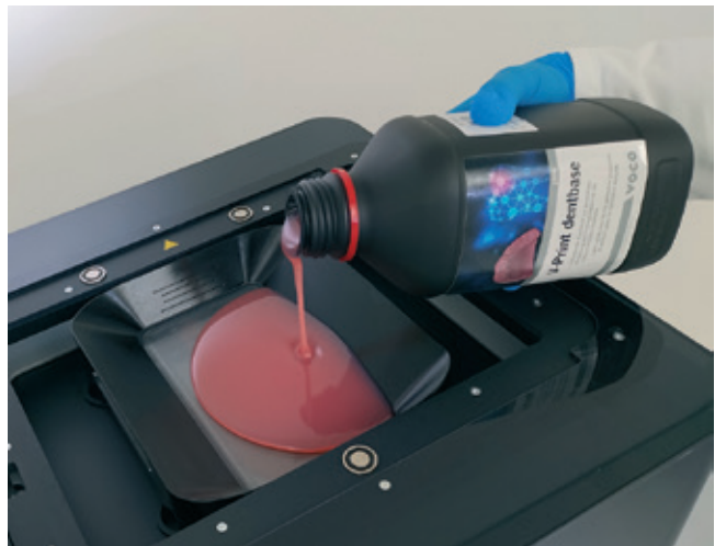
Abb. 3: Befüllen des Druckers mit Druckharz.
