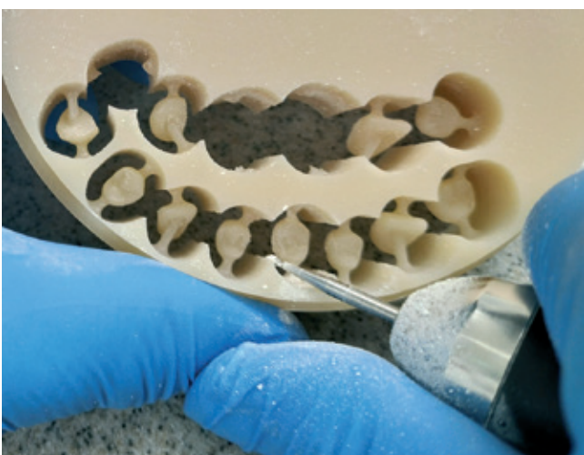
Abb. 9: Heraustrennen der gefrästen Prothesenzähne.
