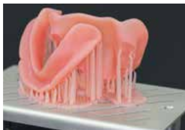
增材制造出的活动义齿基托(人工牙龈)
