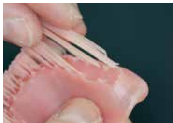
快速去除支撑(可用SolFlex 3D 打印机进行设计)
