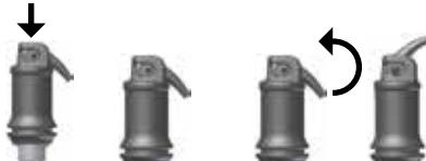
Fig. 1: Aktivering av kapselen
